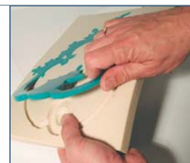
Demolding PU parts in a soft PU mold
